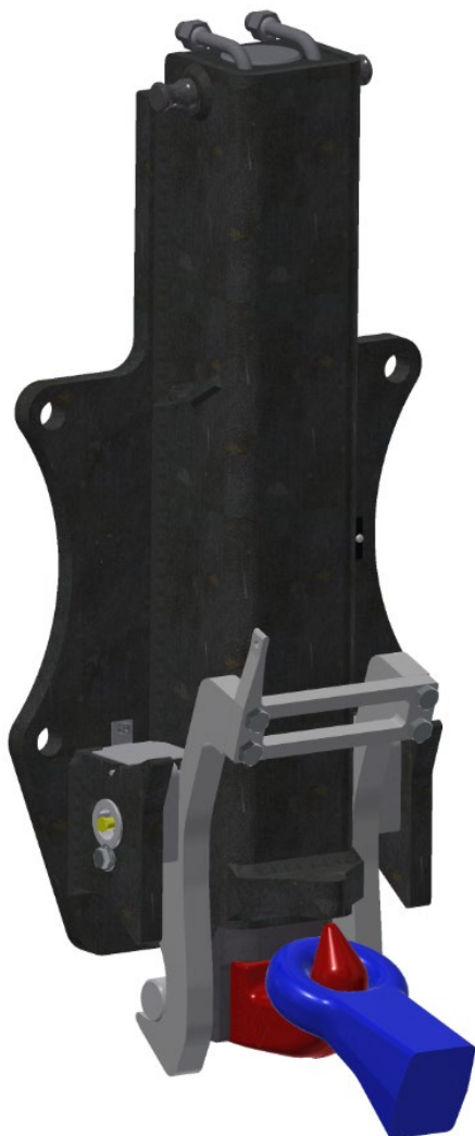
Rysunek 1.1 - zamknięty I sprzęgnięty
