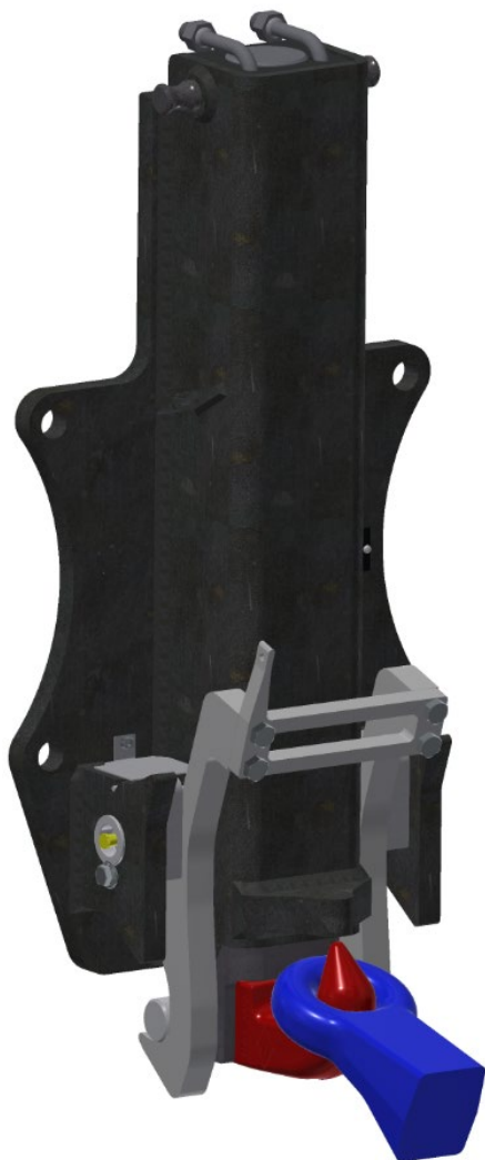
Kuva 1.1 - suljettu ja kytketty
