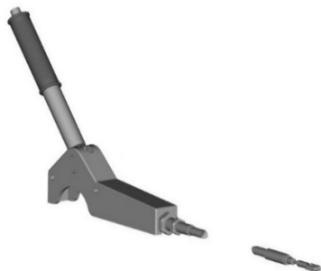
2 pav.: „Bowden“ kabelis su svirtimi
